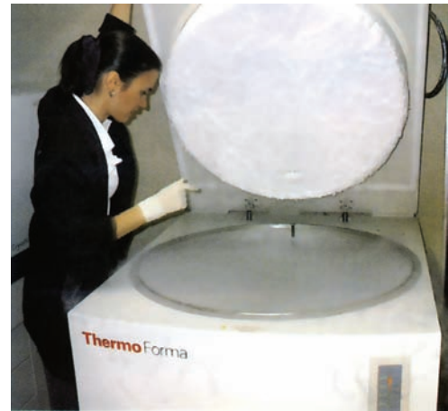
● Figura 45-3 Tanque de almacenamiento. Las unidades permanecen sumergidas en nitrógeno líquido, mientras que en la parte superior del tanque sólo se observa nitrógeno en fase de vapor.
